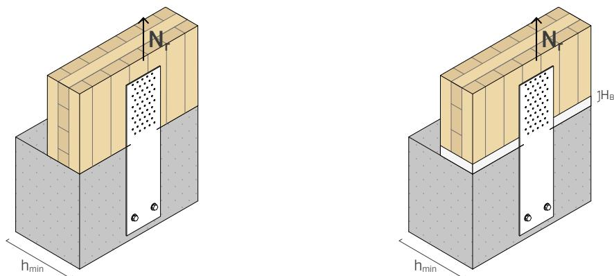
ÉPAISSEUR MINIMALE DU BÉTON  $h_{min} \geq 200$  mm
